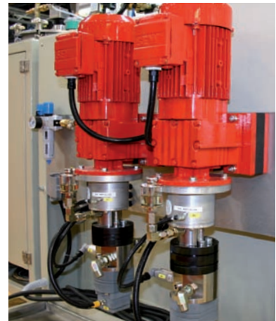
Шестерёнчатый дозирующий насос с объёмным счётчиком для 2 или более компонентов дозирующей установки
